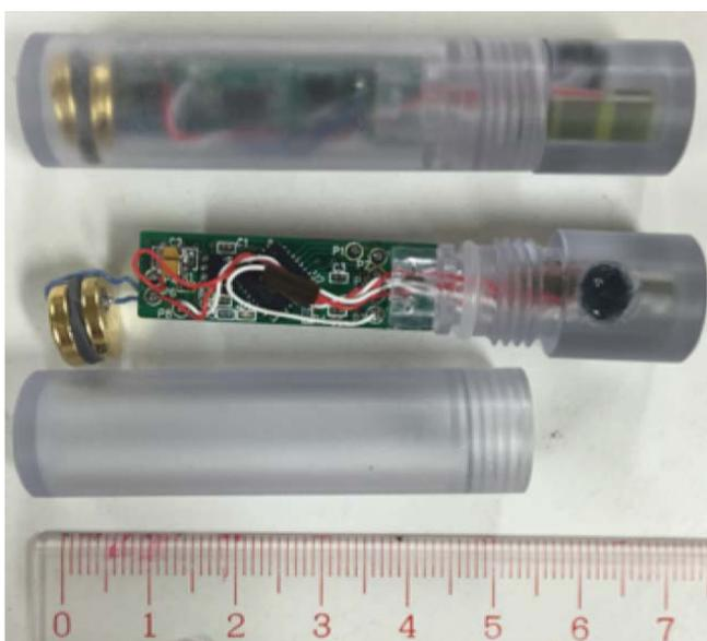
写真 加速度ピンガー（アクアサウンド社製）
