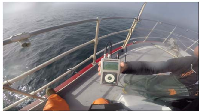
図 2. アルゴス方向探知機でポップアップタグを回収
