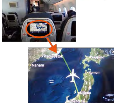
図 1. 機内のモニターに表示された、飛行機の進路と機体の向き。進路と機体の向きは風の影響で必ずしも一致しない。
