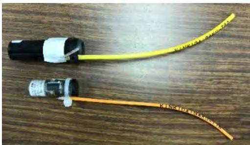
(写真2) 実験に用いたピンガー（上）とロガー（下）
