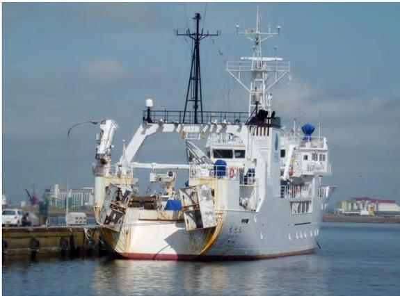
図1. 北光丸 船尾にトロール用のオッターが2つ付いている。
