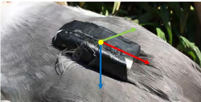
図1. ウミネコの背中に装着されたGPS加速度ロガー。赤矢印が加速度のX軸、緑矢印がY軸、青矢印がZ軸を示す。
