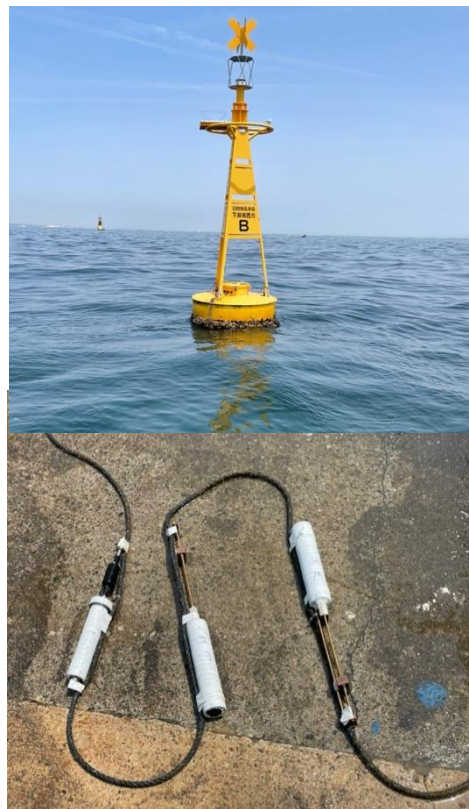
図1. 機材を設置するブイ(上)と研究機材(下)
