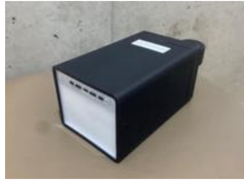
図 6 : LTE-M 通信機能・環境計測ロガー
