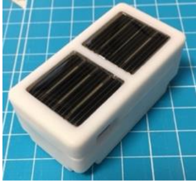
図 7 : LTE-M 通信機能・GPS ロガー
