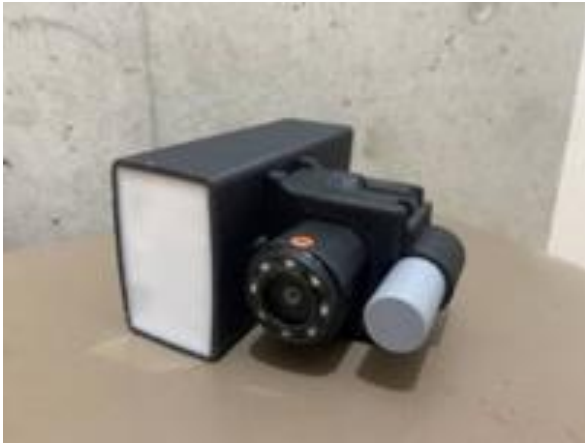
図 3. ハイドロフォン搭載ビデオロガー試作機
