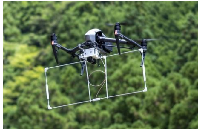
図2 今回の調査で使用したドローンと受信機、アンテナ
