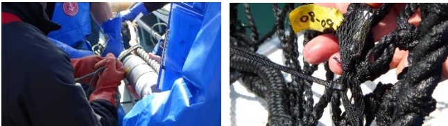
図 1. 受信機を取り付ける様子と網に装着したピンガー
