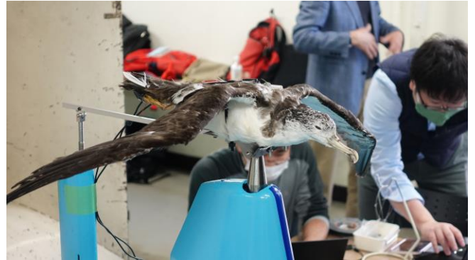
図 1 東海大学でのオオミズナギドリの剥製を使った風洞実験。
