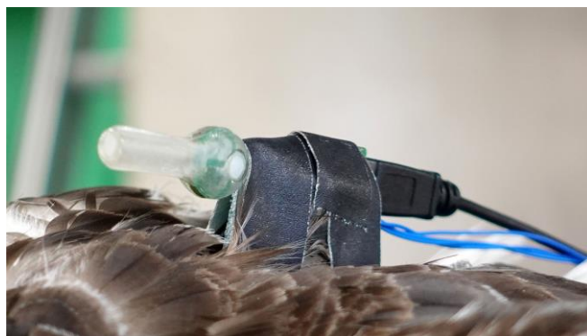
図 2 オオミズナギドリの背中に取り付けられた風速センサ。
