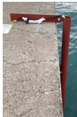
写真3 兵庫県アジュール舞子での設置の様子です。波によって岸壁に機器が打ちつけられないように金属製の筒の中に機器を入れ観測を行なっています。
