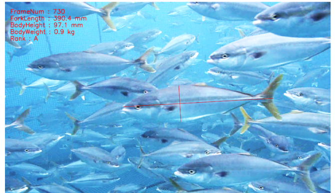
写真 生簀に設置した2眼ステレオカメラ（UC-300, 古野電気社製）で自動的に3次元計測された養殖ブリの魚体長（赤線：尾叉長，体高）。自動計測には画像認識技術が使用され、データは専用クラウドを通じて取得可能。試験生簀は鹿児島県にありましたが、北海道大学の研究室で研究できました。
