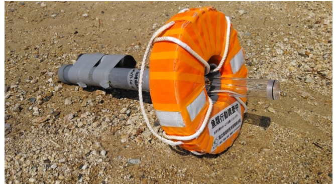
図1. 本研究で用いた漂流式受信機。海流観測用のGPS アルゴスブイに保護用の塩ビパイプと超音波受信機を取り付けた。
