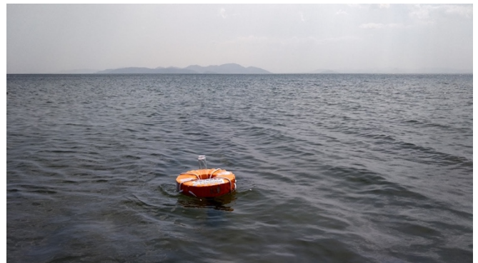
図2. 湖面に投下した直後のブイの様子。河川水が沖へ流れ出す河口で、岸→沖方向に風が吹いているタイミングを狙ってブイを投下するとスムーズに沖合まで運ばれていく。
