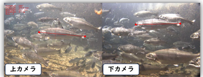
図 2. 使用した光学ステレオカメラは UC-300 (古野電気)。二つのカメラがあることで三角測量の原理で三次元計測することができる。
