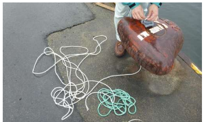
図3. 堤防から音響記録計を下ろす準備の様子。錘もつけて、係留柱や近くの柵に結びつけて、あとは放置。
