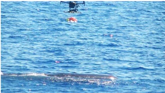
図1. ドローンを用いたロガー吸着
