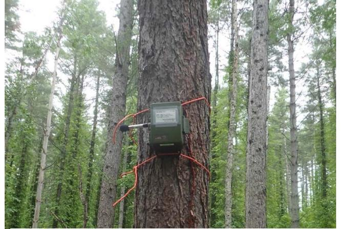
図1. 音声モニタリングに用いる自動録音装置
