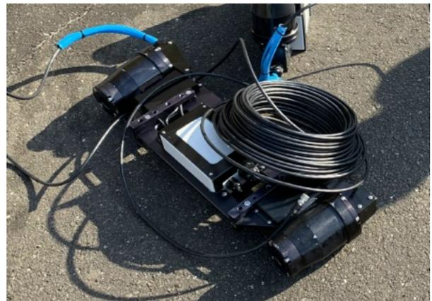
図1：実験に用いた養殖用ステレオカメラ。本来の用途は魚体重計測ですが、その高い3次元計測の性能から遊泳速度計測が可能です。今回の検証によりその精度にお墨付きが得られました。
